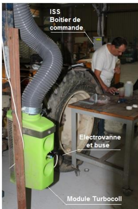
Figure 11 : dispositif testé (ISS / élément de rampe de Turbocoll)
